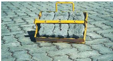
Hình 12. Một tổ mẫu của các viên gạch tốt, trung bình, và không chấp nhận được được nhà máy sử dụng và các công nhân công trường dùng mắt để chấp nhận kết cấu bề mặt của viên gạch. Đây là một phần của toàn bộ chương trình kiểm soát chất lượng tổng hợp và các phương pháp đảm bảo chất lượng được thực hiện trong toàn bộ dự án.
