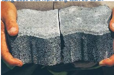
Hình 12. Một tổ mẫu của các viên gạch tốt, trung bình, và không chấp nhận được được nhà máy sử dụng và các công nhân công trường dùng mắt để chấp nhận kết cấu bề mặt của viên gạch. Đây là một phần của toàn bộ chương trình kiểm soát chất lượng tổng hợp và các phương pháp đảm bảo chất lượng được thực hiện trong toàn bộ dự án.
