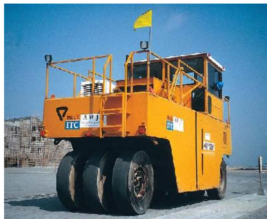
Hình 18. Xe lu nặng 44 tấn lăn trên toàn bộ bề mặt của lớp thấm (trước khi sử dụng chất nối khe) để kiểm chứng các lớp thấm đã được lấp và các khe đã đầy cát.
